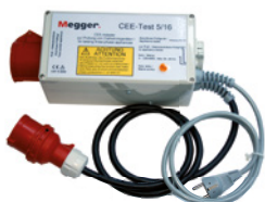
Drehstrom-Adapter CEE-Test 5/16 Aktiver CEE-Adapter mit Differenz- strommessung zum überprüfen von Drehstrom- Geräten bis 16 A (DE-050) oder bis 32 A (DE-051) Item no. DE-050 / DE-051
